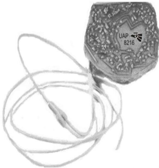
Fig. 14. Marcapaso cardiaco de frecuencia fija diseñado y fabricado en el Departamento de Semiconductores de la UAP en 1982, los componentes electrónicos empleados en este marcapaso fueron también fabricados en dicho departamento. Este marcapaso se implantó en perros.
